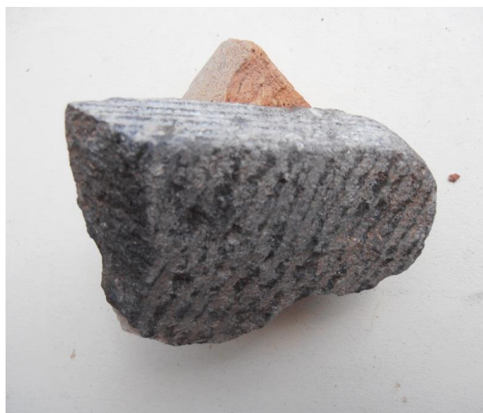
Gedeelte van een Belgische hardstenen dorpel, aan de bovenzijde voorzien van frijnslag en een gescharreerde zijkant
